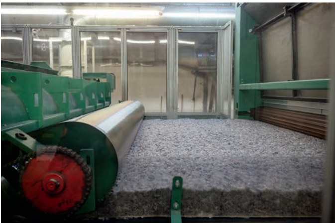
Dazu werden Laken, Hemden, Jeans in Reißfasern zerkleinert. Anschließend werden Vliese mit unterschiedlichem Materialgewicht daraus hergestellt.
