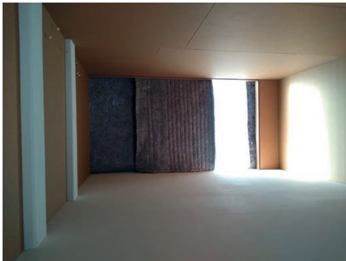
Im 1:10 Modell der Teeküche / Besprecher wird Raumwirkung und Lichteinfall der Prototypen getestet.
