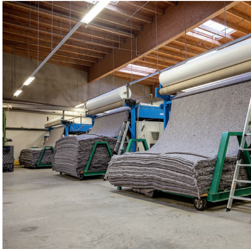
In einem Näh-Wirk-Verfahren (Maliwatt) wird das Vlies erneut zu einem robusten Stoff, u.a. für Packdecken.
