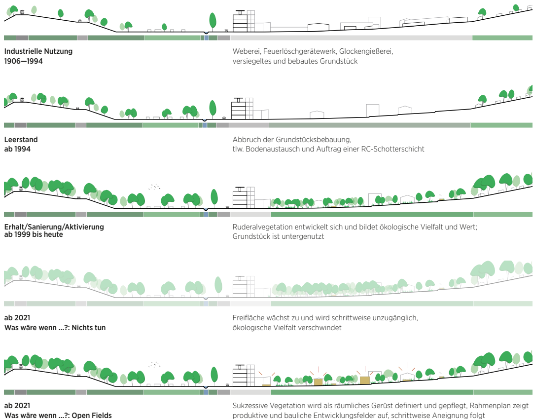
Schematische Schnitte durch die Liegenschaft Eiermannbau und umliegende Areale entlang der Nutzungsgeschichte des Standorts. Mit der Idee der Open Fields wird ab 2021 ein integrierter Ansatz aus vorgefundener Landschaft und neuen Entwicklungsfeldern verfolgt. Grafik: Treibhaus Landschaftsarchitekten
